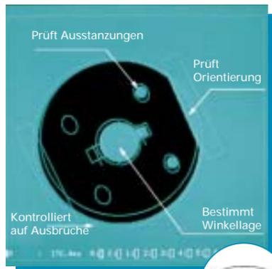
Maß- und Positionskontrolle mechanischer Bauteile
