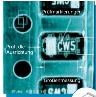
Lage- und Maßkontrolle von Kondensatoren
