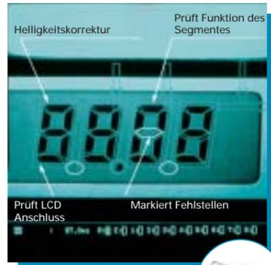
Fehlererkennung an LCD-Displays
