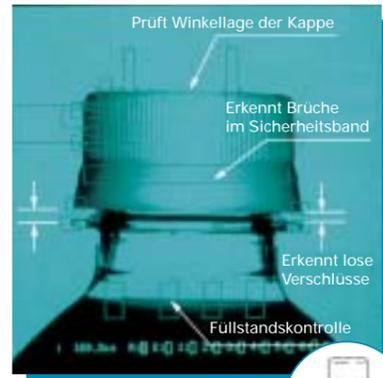
Füllstandsmessung an Flaschen
