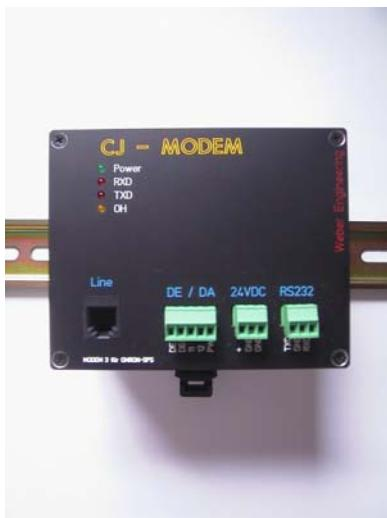
Das Industrie-MODEM ist das Standardprodukt für die Fernwartung und –programmierung aller gängigen OMRON-SPS-Systeme. Das MODEM ist speziell auf die OMRON-Systeme abgestimmt und erfordert kein kompliziertes und aufwendiges Einstellen der MODEM's mehr.
