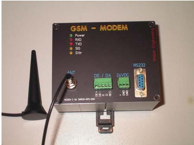
Das Industrie-MODEM ist das Standardprodukt für die Fernwartung und -programmierung aller gängigen OMRON-SPS-Systeme. Das MODEM ist speziell auf die OMRON-Systeme abgestimmt und erfordert kein kompliziertes und aufwendiges Einstellen der MODEM's mehr.
