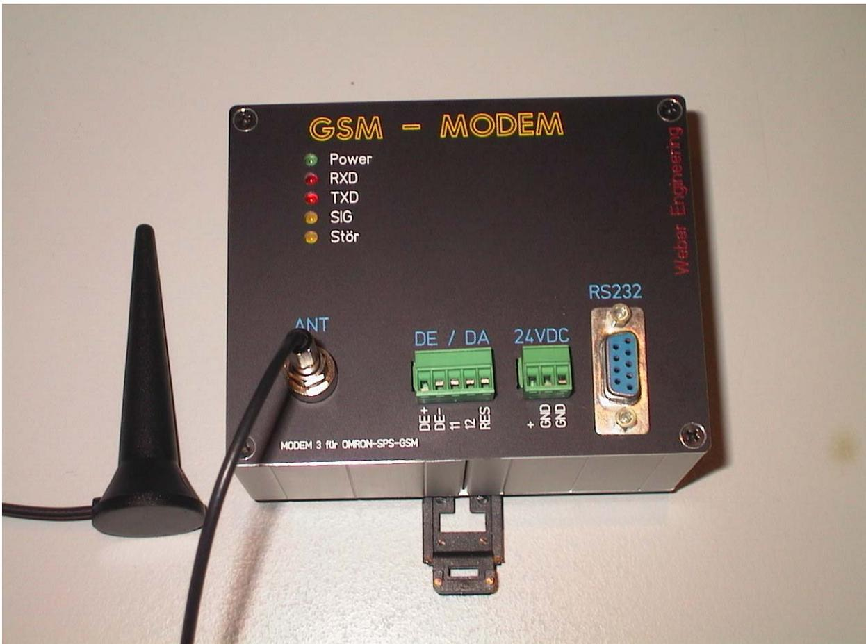
\* Photo von Prototyp, Originalgerät hat für RS232 einen 3 – pol. Phoenix - Stecker
