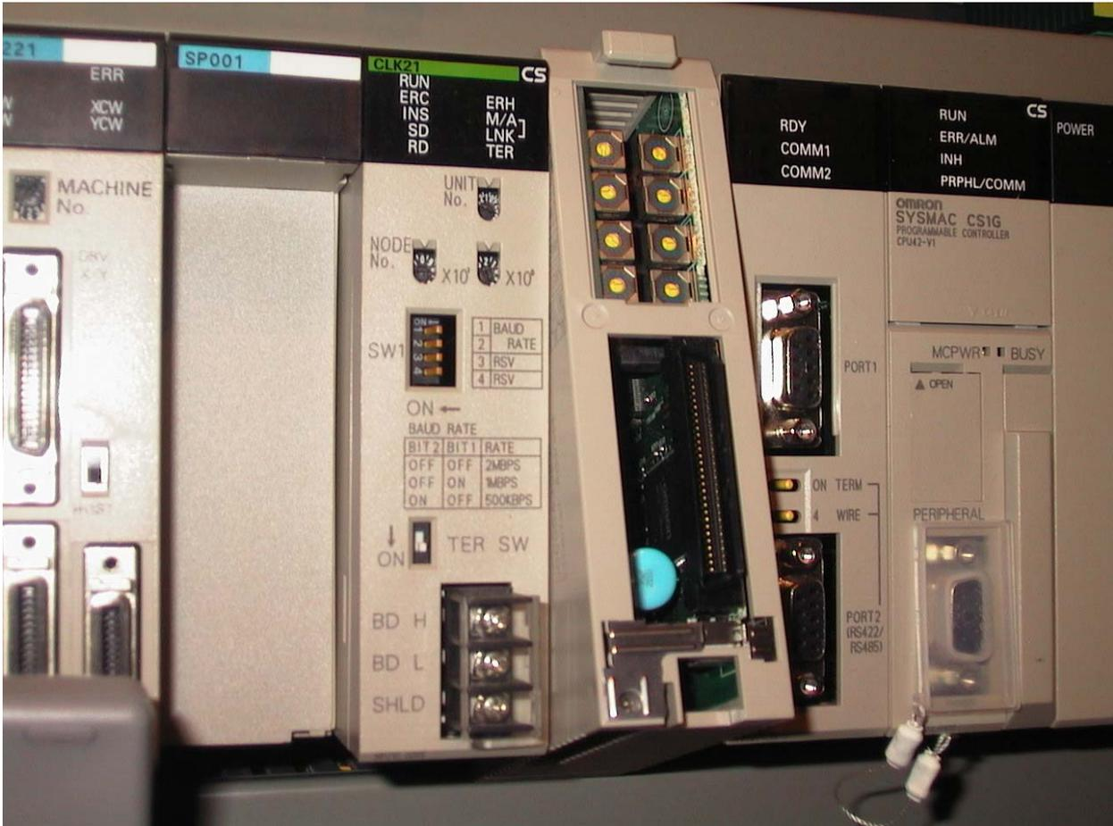
Bild 04 : Schalter zur Einstellung der IP-Adresse
