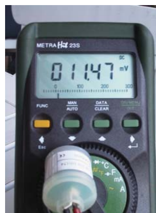
Bild 02 Sauerstoffsensor und Voltmeter
